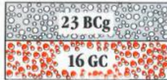
Figures VI.4 - la structure de la chaussée
