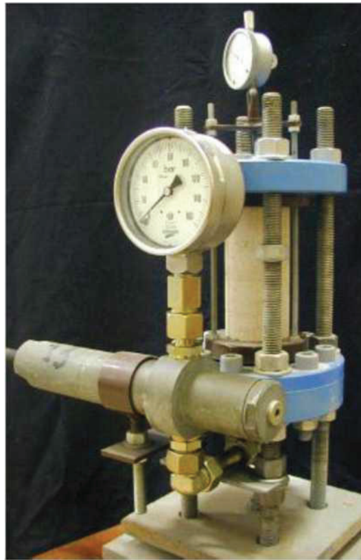
Fig.III.10 : Dispositif expérimental pour un essai de compression uni axiale
