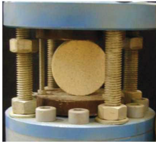
fig.III.11 :Essai de traction indirecte (essai brésilien)
