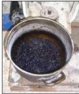
Fig.V.5 : Enrobé après malaxage
