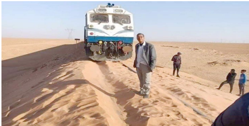
Figure I:1 Accumulation des sables sur les rails
