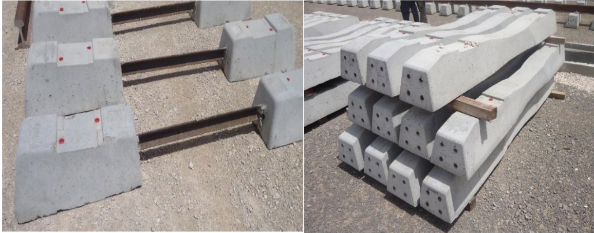
Figure III:4 Traverses en béton (Traverses bi bloc / Traverses mono bloc)
