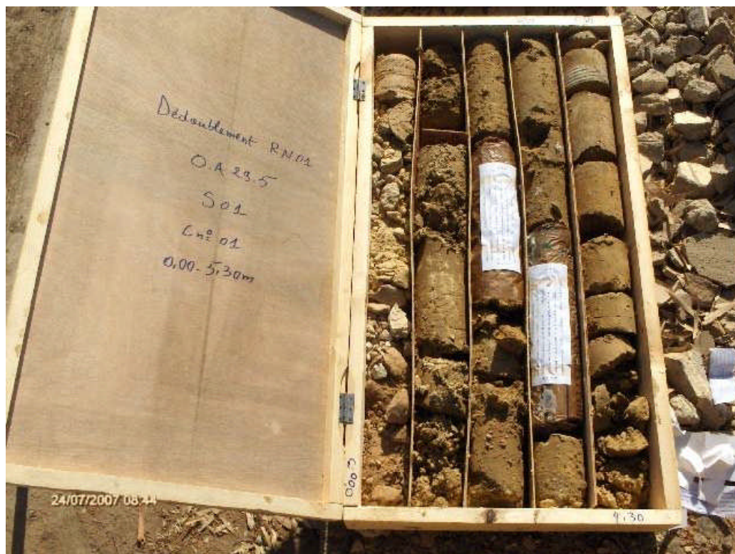
Sondage S-1 Profondeur du 0,00 m a 5,30 m
