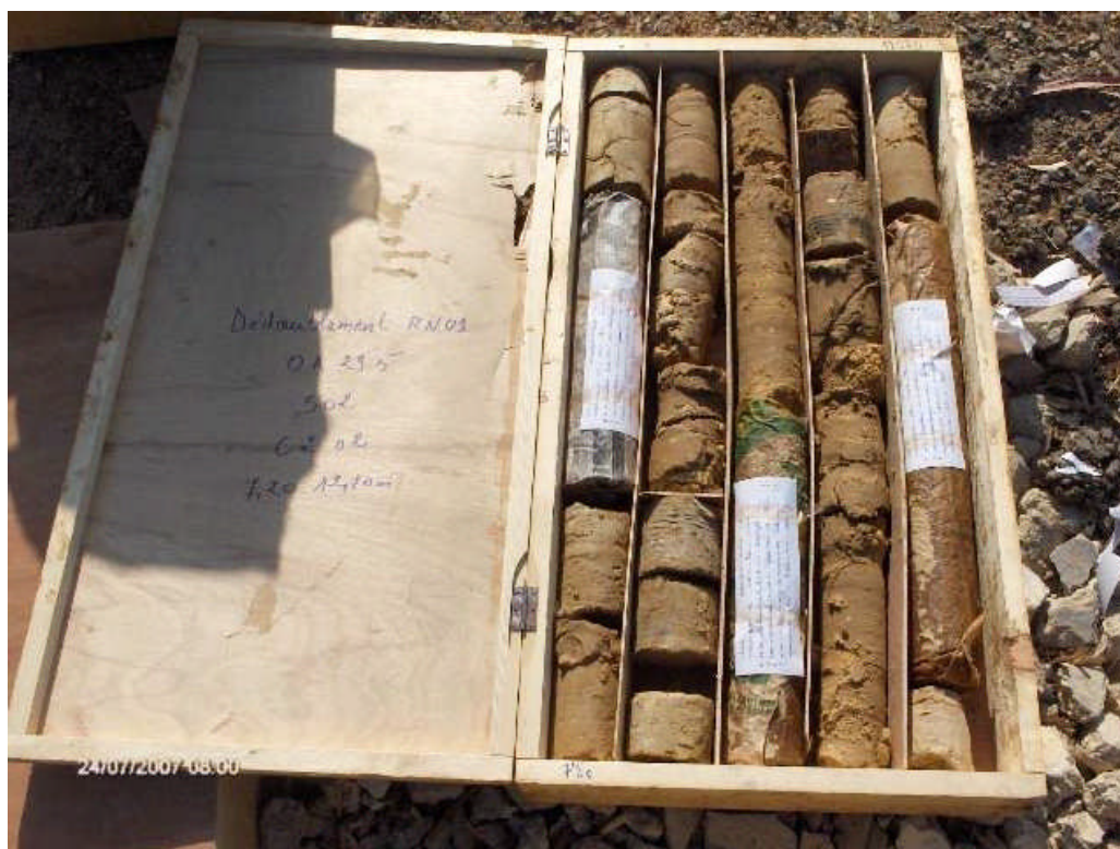
Sondage S-2 Profondeur du 7,20 m a 12,70 m
