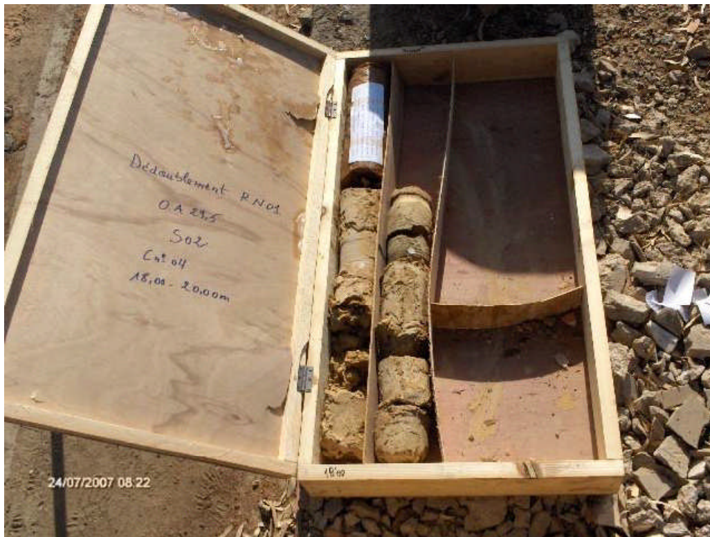
Sondage S-2 Profondeur du 18,00 m a 20,00 m
