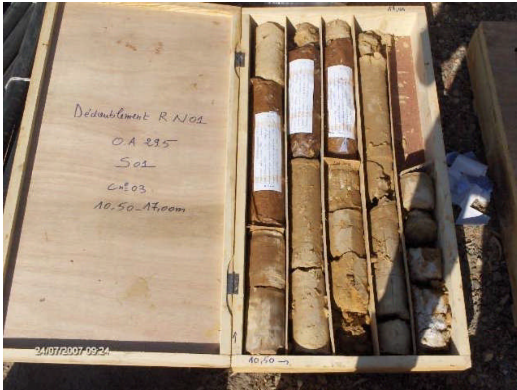
Sondage S-1 Profondeur du 10,50 m a 17,00 m
