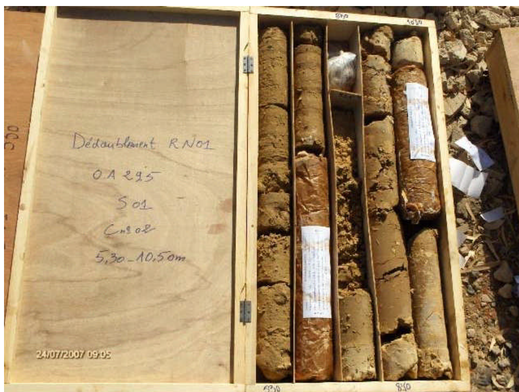
Sondage S-1 Profondeur du 5,30 m a 10,50 m
