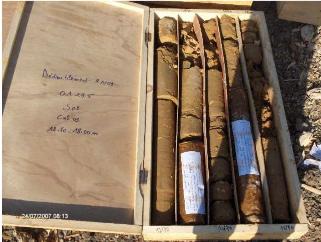
Sondage S-2 Profondeur du 12,70 m a 18,00 m
