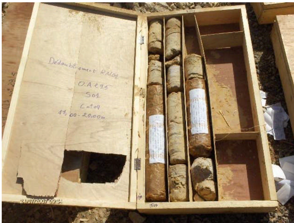
Sondage S-1 Profondeur du 17,00 m a 20,00 m
