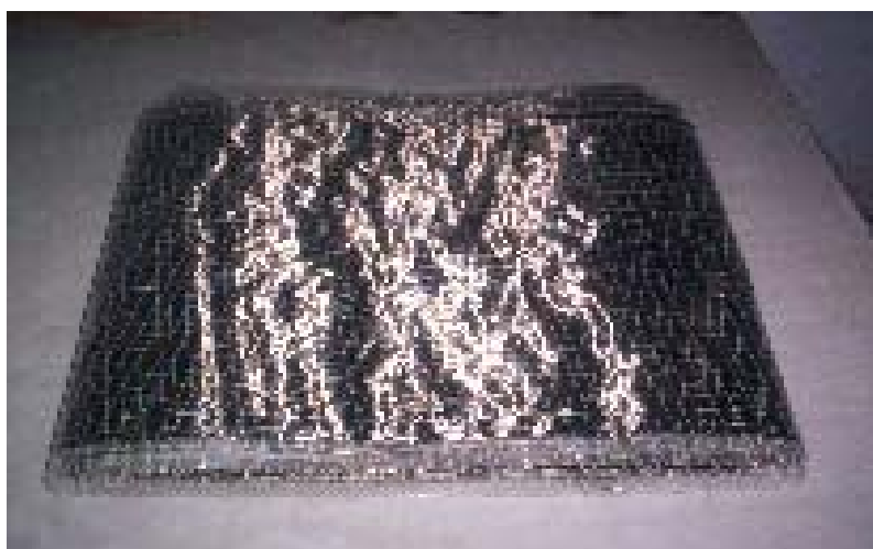
Figure 3-5 Sika Wrap (tissu monodirectionnel).
