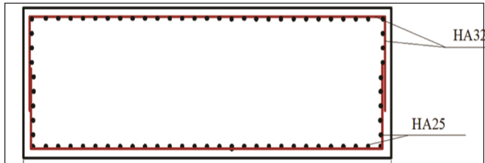
Figure XI.8. Ferrailage de la semelle sous culée
