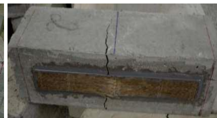
Fig.15 : Renfort composé de fibres ayant rompu lors d'un essai de flexion [18]
