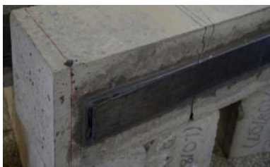
Fig.13 : renfort en carbone décollé après un essai de flexion [18]
