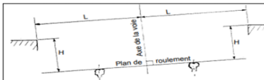
Figure X-6 : La hauteur du quai et la distance par rapport à l'axe de la voie.
