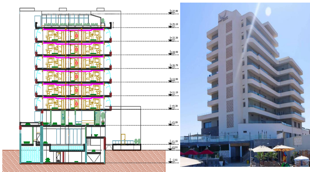
Figure II.10 : Irrégularité en élévation de l'Hôtel Falcon Thalassa.
