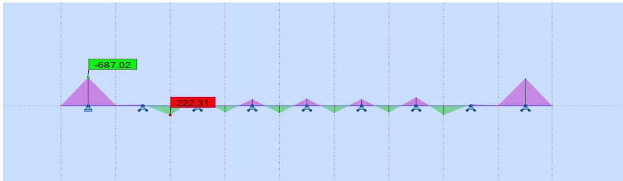
Figure VI-8: Diagramme du moment à l'ELU
