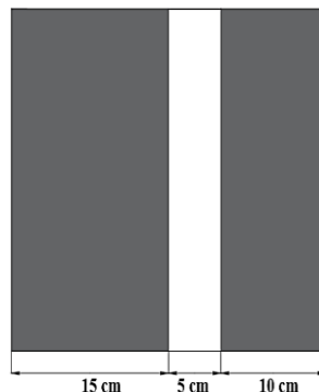
Figure 0-5 : Schéma en coupe des cloisons extérieures
