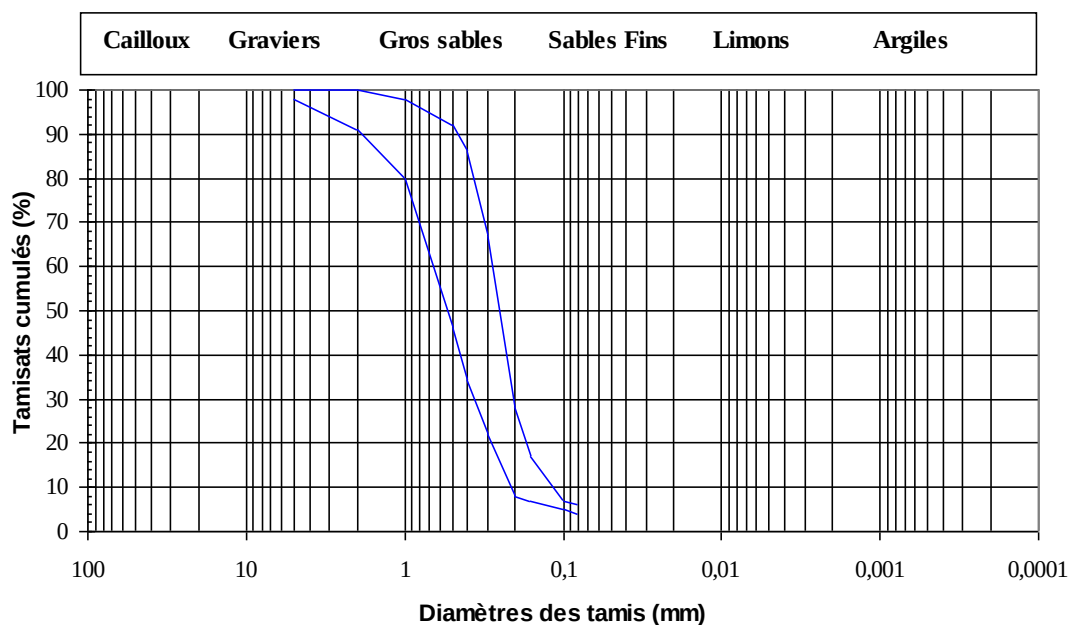
FigureError! No text of specified style in document.-2Fourchette du fuseau granulométrique de l'alternance de sable et de grès
