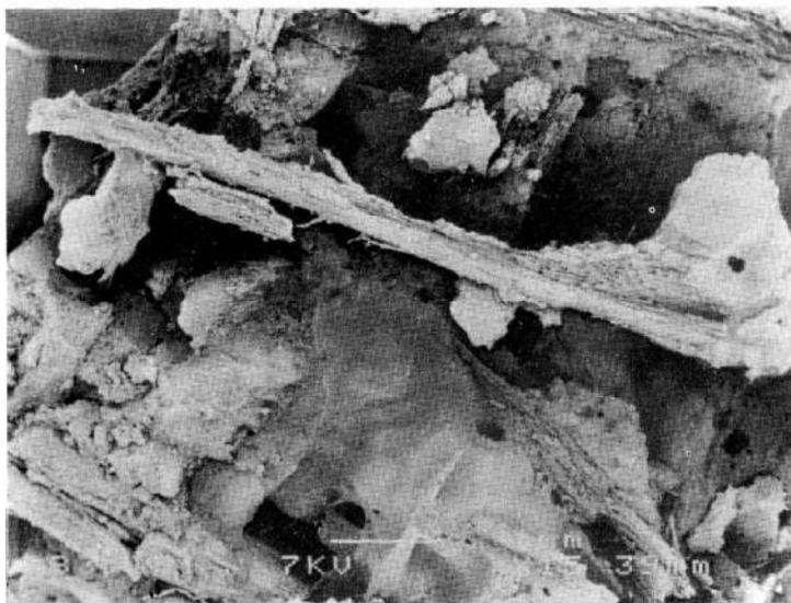
Photo 1 : Vue générale. Défaut autour d'un copeau (X5).
