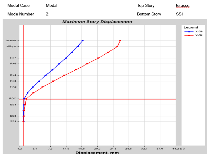
Figure IV.5 : Déformée modale correspondant au deuxième mode de vibration
