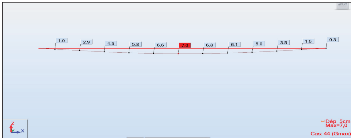
Figure VII.1 Flèche due au poids propre
