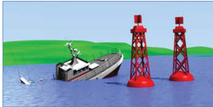
Figure VIII. 19: Balisage au droit d'un bateau qui vient de couler
