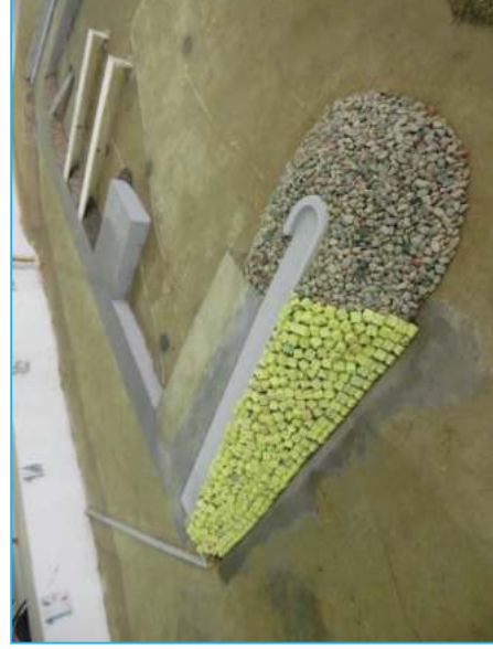
Figure D. 30 : Vue de la jetée secondaire de la variante 2.1 avant essai.
