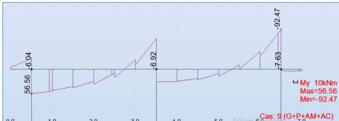
Figure VII. 19: Moment fléchissant du chevêtre de la combinaison défavorable
