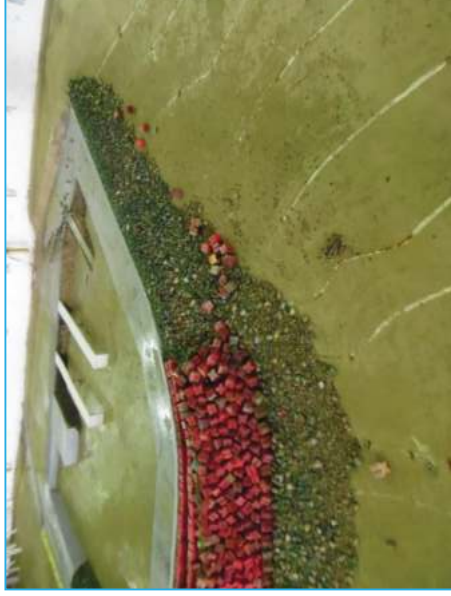
Figure D. 46: Vue de la variante 2.2 après essais. -Glissement de plusieurs BCR de 30 t au niveau coude.
