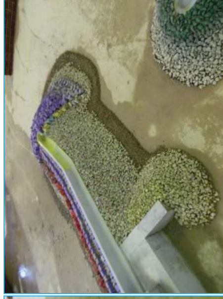
Figure D. 61 : Vue de la variante 2.4 après essai, musoir.
