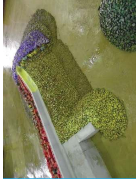
Figure D. 47: Vue de la variante 2.2 après essais. -Erosion au niveau du talus intérieur du profil au droit du musoir de la jetée principale.
