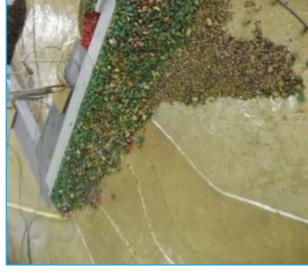
Figure D. 21: Vue du musoir de la variante 2(APS) après essai
