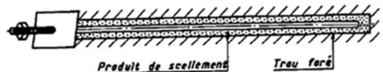
-Boulon à scellement réparti-
