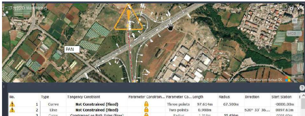
Figure IV-20: Détection des anomalies.
