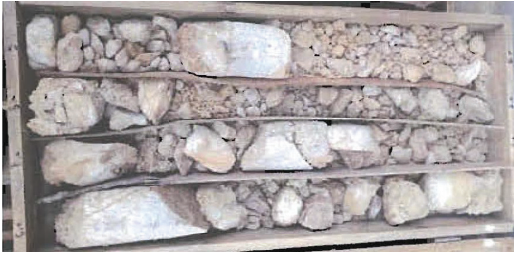
Figure A-7 : Investigations géotechniques (SC2) – Caisse 02 :5 à 9 m
