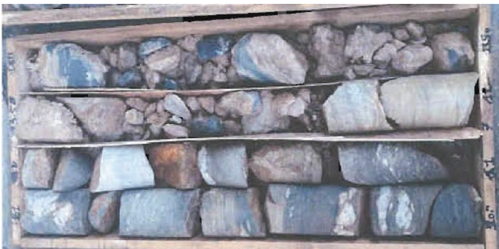
Figure A-3 : Investigations géotechniques (SC1) – Caisse 03 : 10 à 15 m
