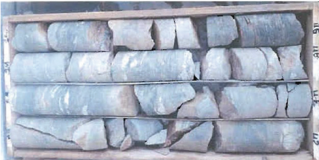
Figure A-2 : Investigations géotechniques (SC1) – Caisse 02: 6 à 10 m
