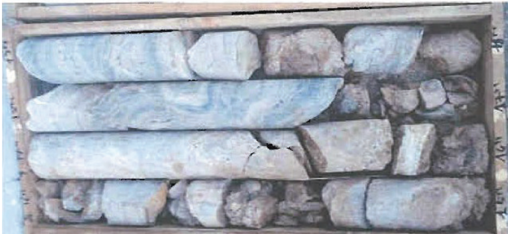
Figure A-4 : Investigations géotechniques (SC1) – Caisse 04 :15 à 19 m
