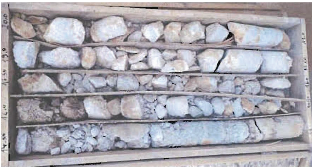
Figure A-9 : Investigations géotechniques (SC2) – Caisse 4 :13 à 20
