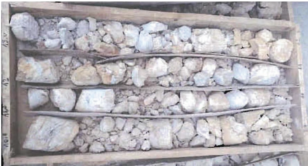
Figure A-8 : Investigations géotechniques (SC2) – Caisse 3 :9 à 13 m
