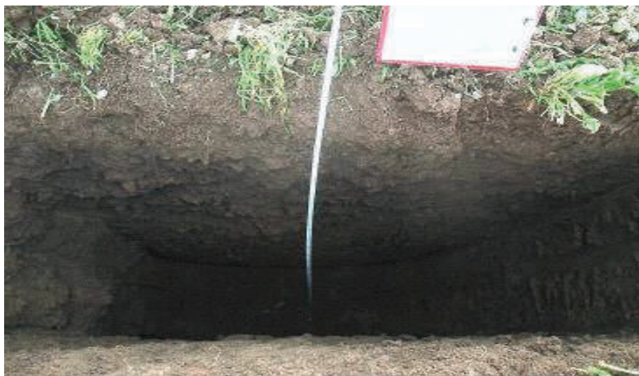
Figure VII. 3 Puit de reconnaissance 12 (00.00 à 03.50m)
