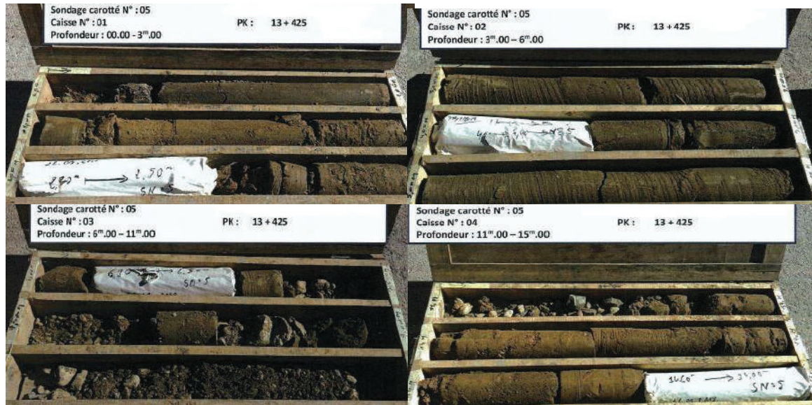
Figure VII. 4 Sondage carotté 05 (00.00 à 15.00m)
