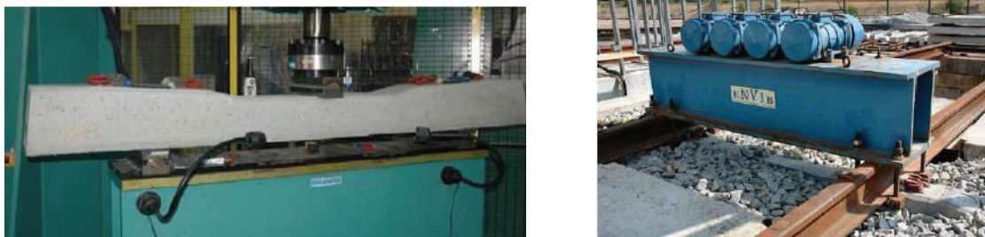
Figure I. 12 Essais pour traverse dans laboratoire de SNCF
