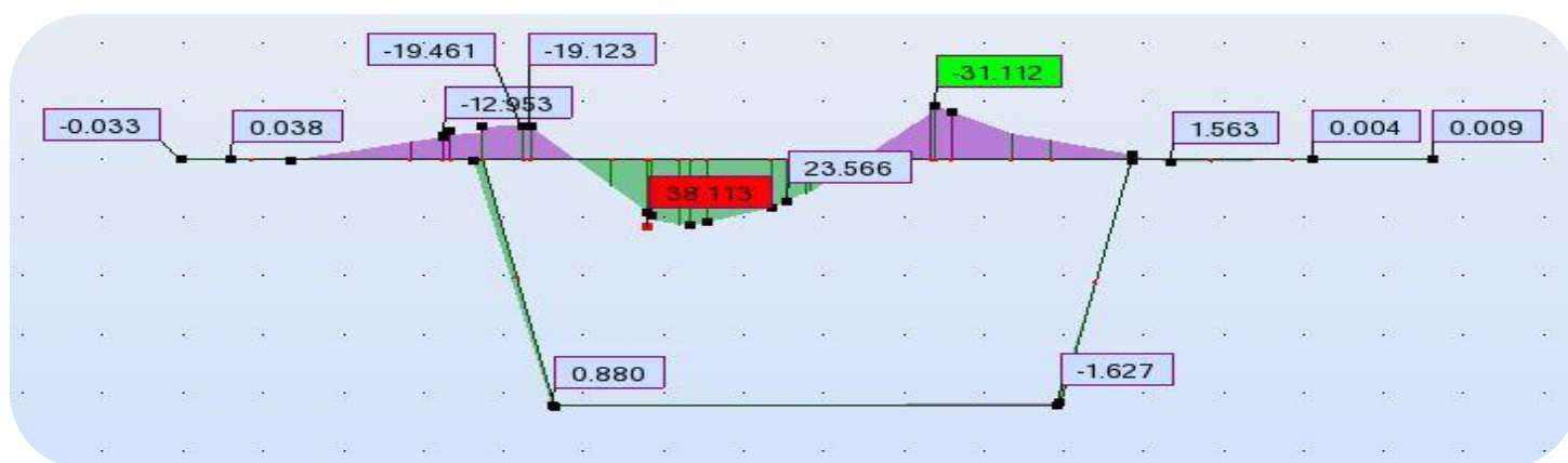
Moment transversal sous surcharge : Bt
