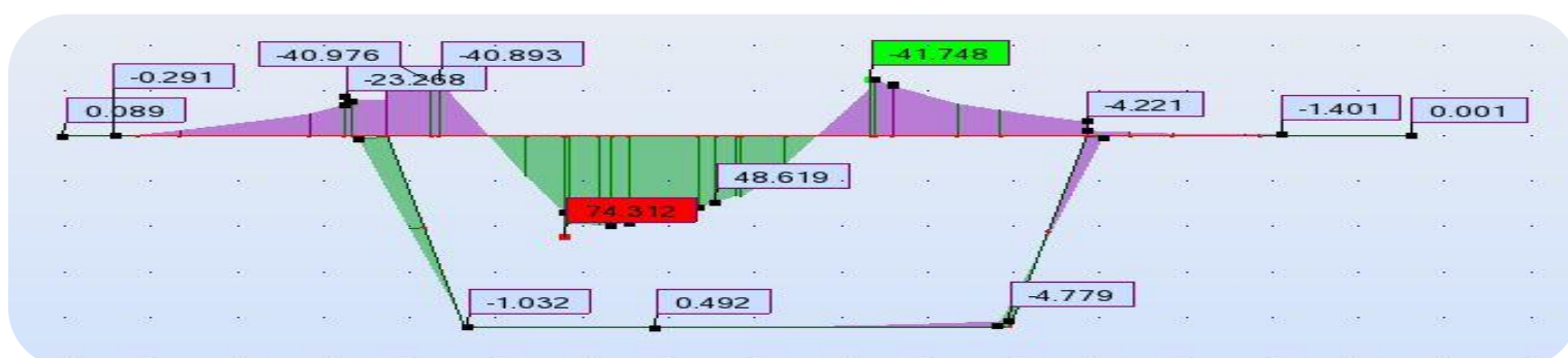
Moment transversal sous surcharge : G + 1,2(B C + ST) + 0,5T
