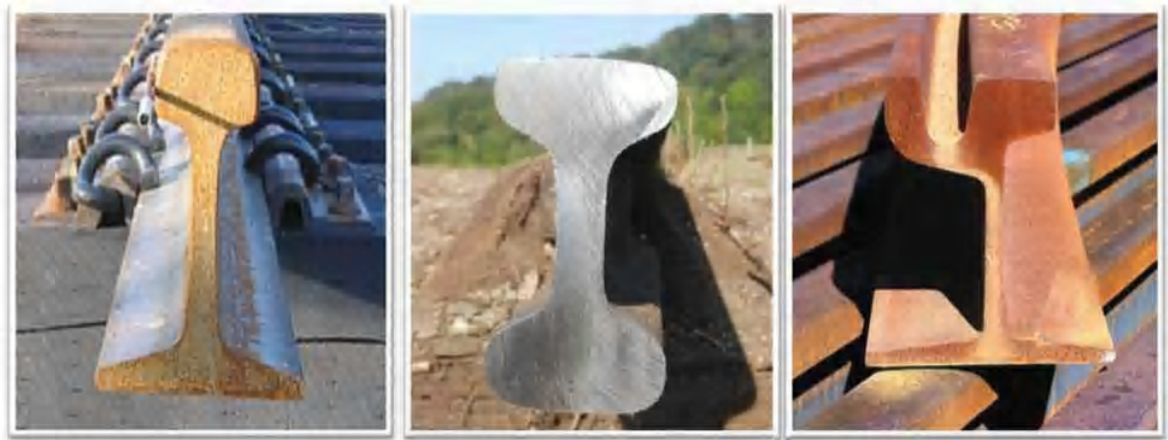
Figure III 3 Les différents types de rail (de gauche à droite : Rail Vignole, Rail à double champignon, Rail à gorge) [5]
