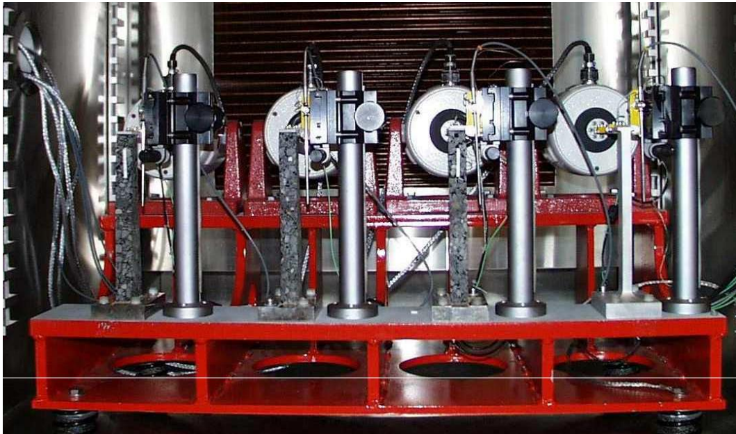
Figure 0.2: Appareil de l'essai de flexion 2 points (LCPC-Nantes – France) [2]
