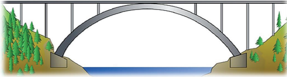
Figure I.11 pont à tablier supérieur
