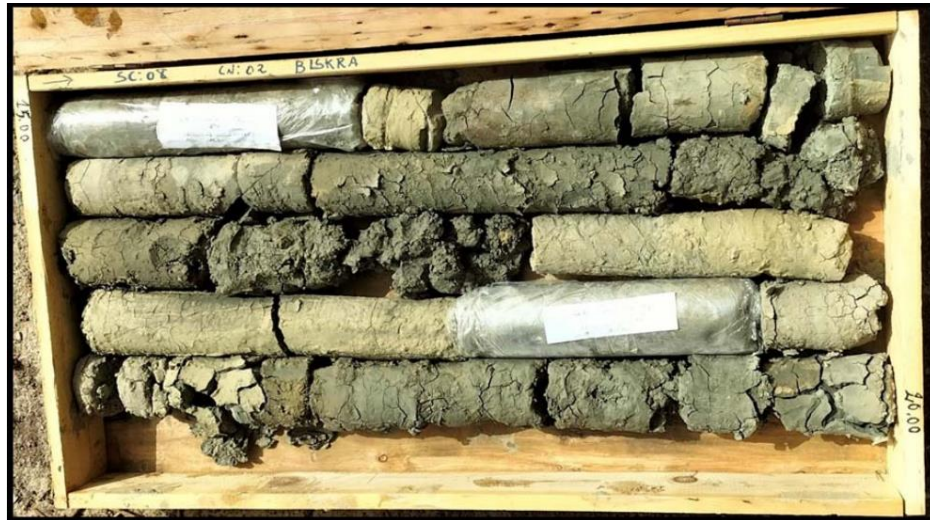
Sondage (Sc 01) Caisse N° 04 : (15.00 –20.00) m
