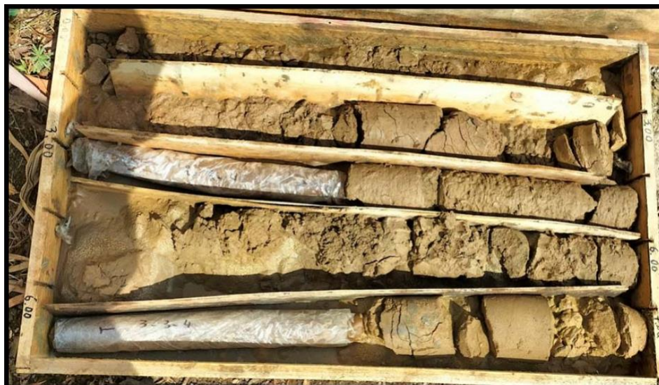
Sondage (Sc 05) Caisse N° 01 : (00.00 –07.00) m
