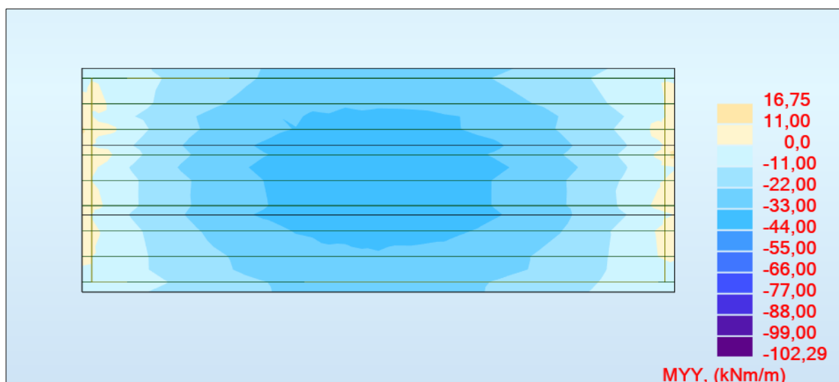
Figure VII.10 : Diagramme du moment fléchissant Myy à l'ELS
