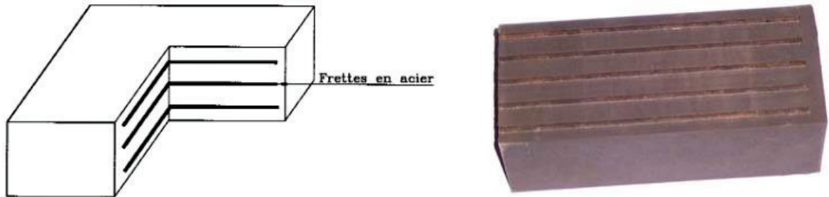
Figure I.21 Schéma type d'un A-A en Elastomère fretté (coupe)
