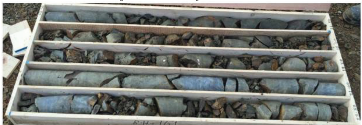
Figure A.4 Figure 4 Photo du sondage carotté BH-141
