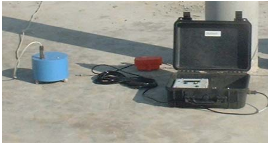
Figure V.1 : Appareillage d'enregistrement du bruit de fond
