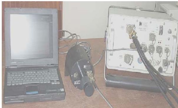
Figure V.11: Appareillage d'enregistrement des vibrations ambiantes
