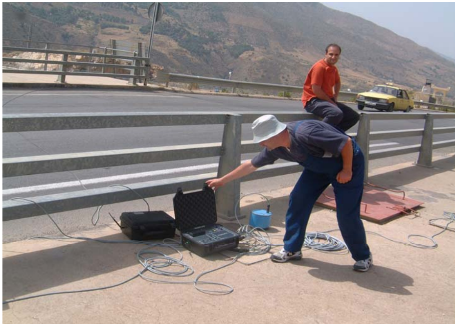
Figure V.5 : Manipulation d'enregistrement du bruit de fond sur le pont
