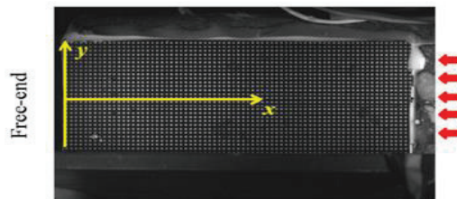
Figure I.15. Image d'un spécimen avec un motif de grille au pas de 1 mm pris avec une caméra Shimadzu HPV-X2 à 2 Mfps.
