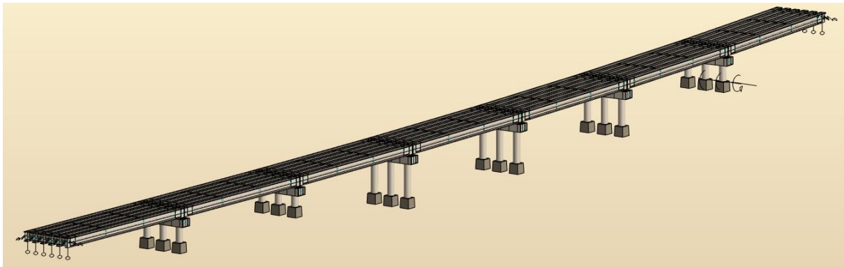
Figure XI. 3 Modèle numérique de l'ouvrage pour l'analyse spectrale
