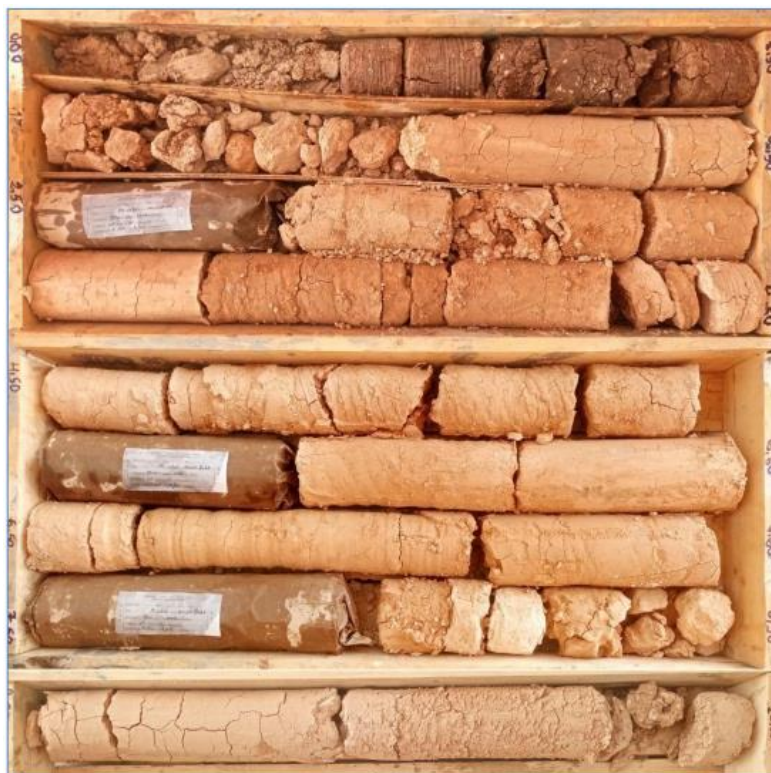
Figure IIX - 8 Sondage carotté au PK 00+875 de 0m à 10m
