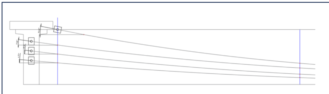
Figure VI-10 : Tracé des câbles (coupe longitudinale).
