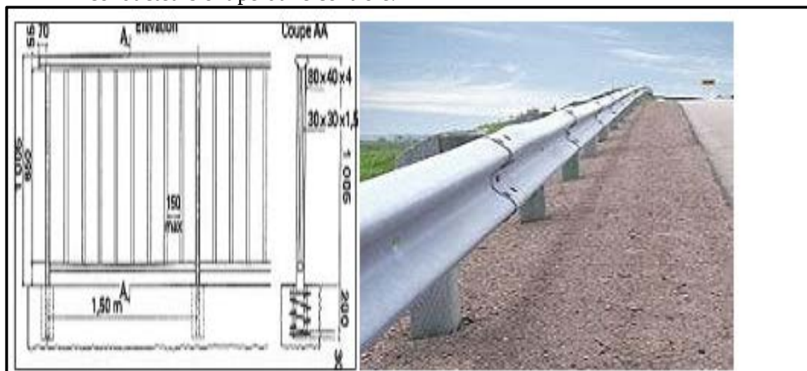
FigXV.4 : Dispositifs de retenue.
