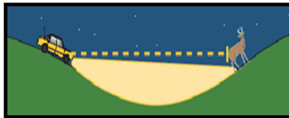
Figure IV.3-3 visibilité en angle rentrant (raccordements concaves)
