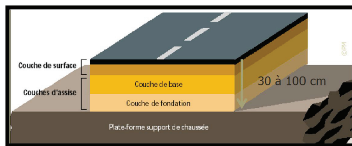
Figure VI.2-1 structure type d'une chaussée souple
