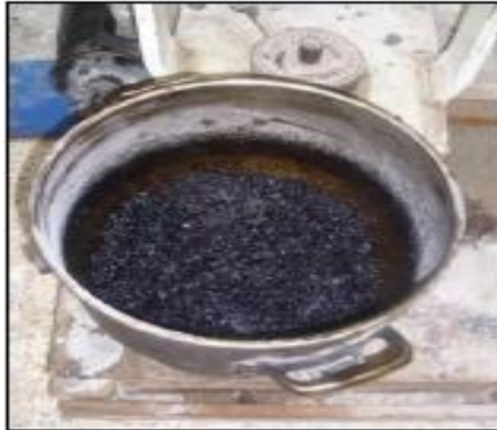
Figure 35: Enrobé après malaxage
