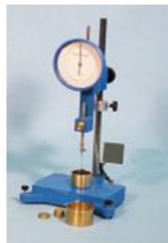
Figure 1:Schéma de pénétrabilité pour le bitume et Pénétrömètre à aiguille (SAOUDI, Nacira).
