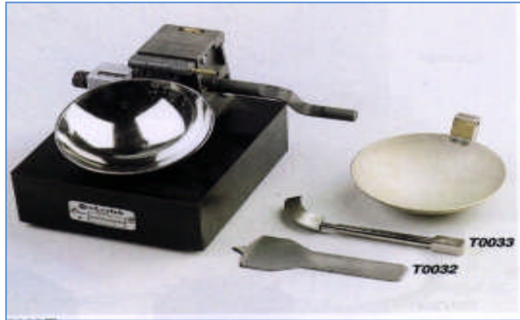
Schématization de l'appareil de Casagrande
