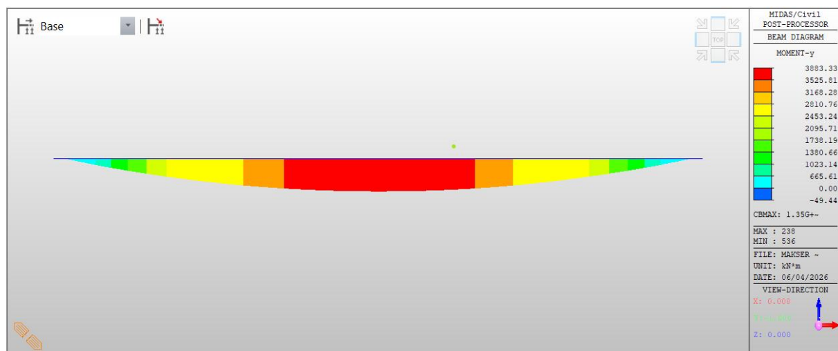
Annexe E.13 : Diagramme du moment fléchissant M_y — ELU BC2 — Pont testé n°1
