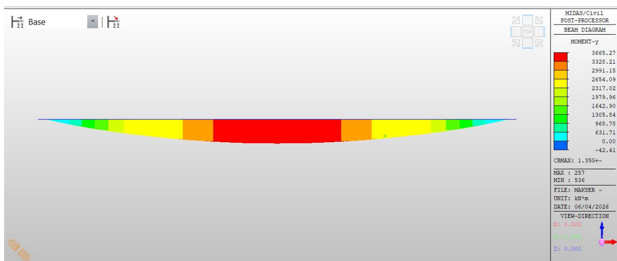
Annexe E.14 : Diagramme du moment fléchissant M_y — ELU BT2 — Pont testé n°1
