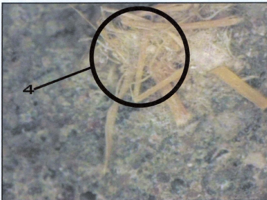
Photo 11: Après écrasement de l'éprouvette, agglutination de fibre (grossissement x50)
