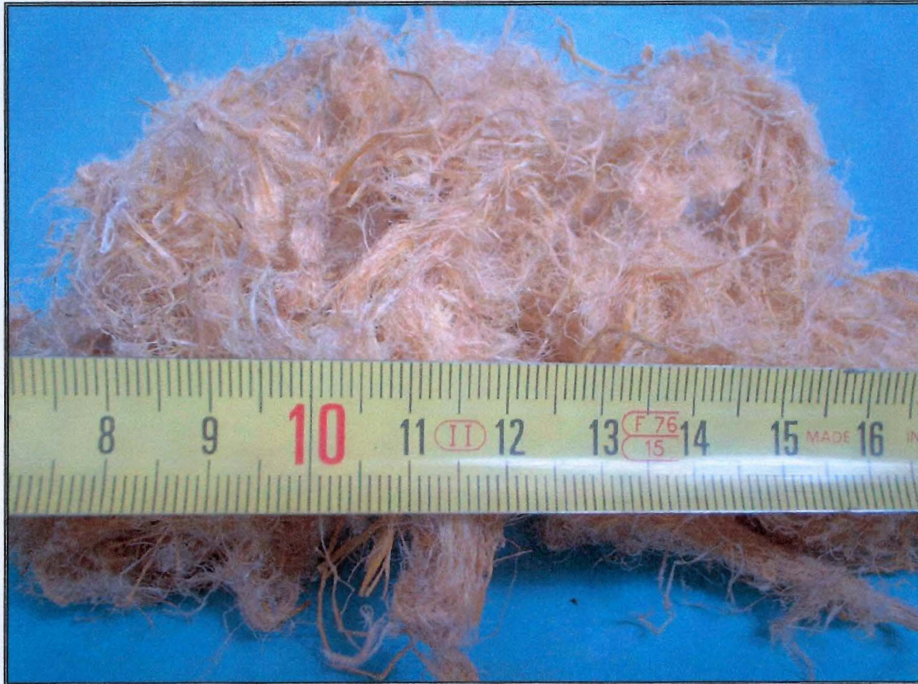
Photo 2: Pâte cellulosique d'Alfa après macération et défibrage
