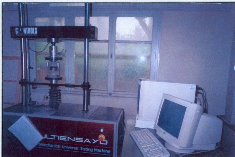
Photo 15 : Appareillage de compression utilisé pour le mortier
