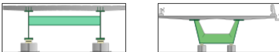
Figure.I.8 : Ponts à poutres mixtes acier/béton
