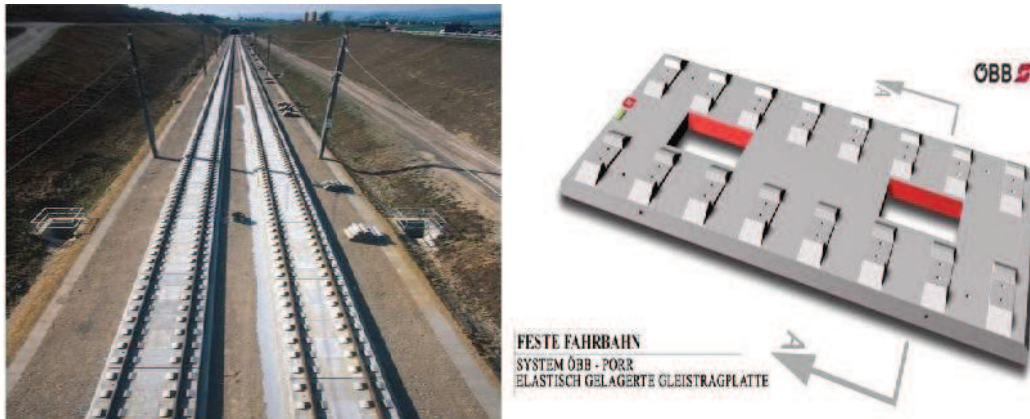
Fig. III.24 : Voie en dalle béton préfabriquée et Partie d'une dalle préfabriquée
