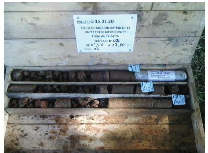
FigureVII.2 : sondage n°03 de profondeur 07.50 a 12 m
