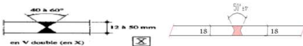
Fig.7.25. condition et détails de soudure d'âme.
