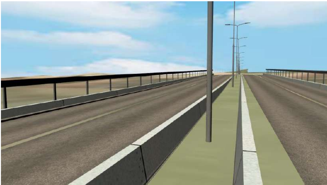
Figure 1-8: Illustration du profil en travers sur ouvrage
