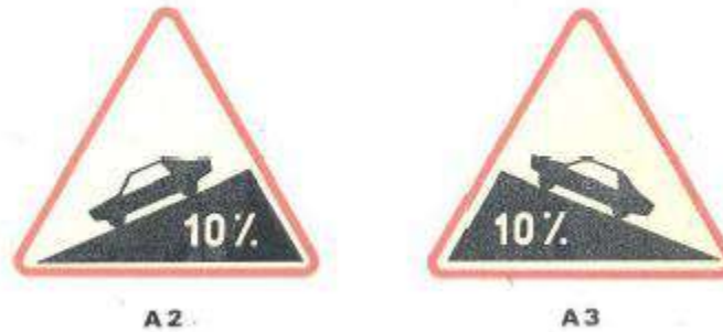
Figure 3-2: Signalisation des pentes et rampes dangereuses
