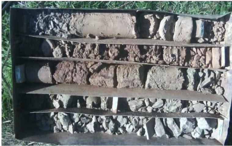
Caisse n°01/05 Profondeur: 0,00 à 5,00 m
