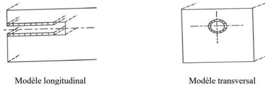
Figure I.3 : Modèle longitudinal et transversal du tunnel.
