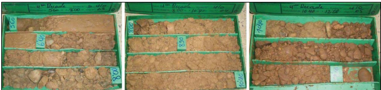
Annexe A. 4 : Vue de l'unité de gravier a argile/sable dans le sondage S-410.
