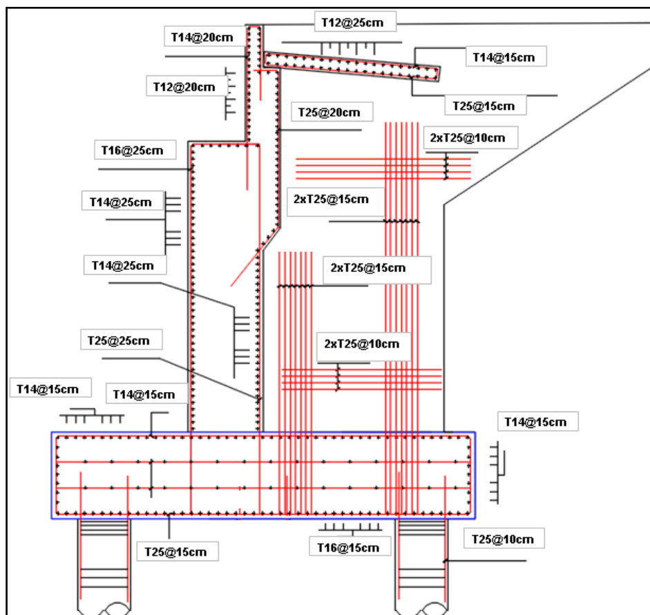
Figure XIII-4 : Schéma de ferrailade la culée.
