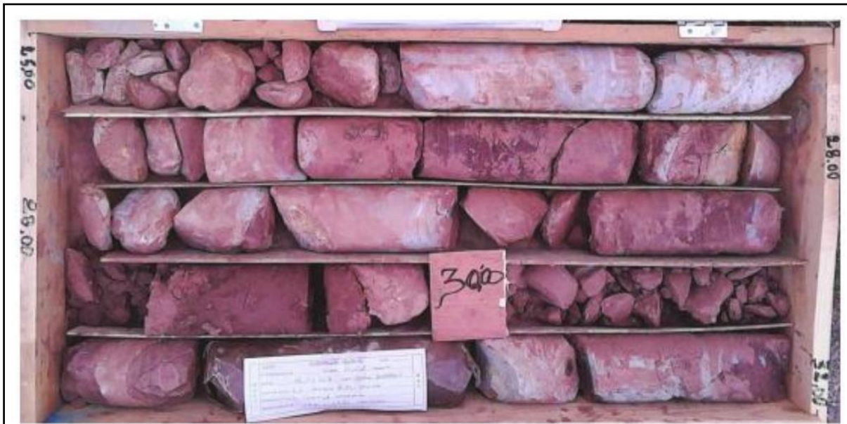
Figure A.7 : Investigations géotechniques de la pénétrante de la ville de Guelma à l'autoroute E-O Sc 09 PK 27+000 – Caisse 04 : 25.00 à 32.00m
