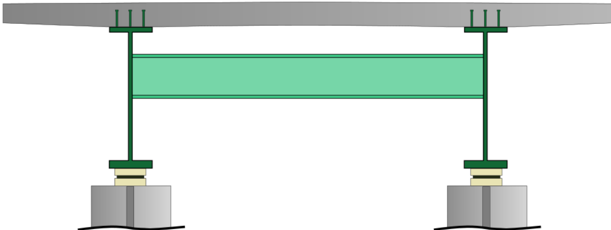
FIGURE II.3 – Coupe transversale pont mixte bipoutre
