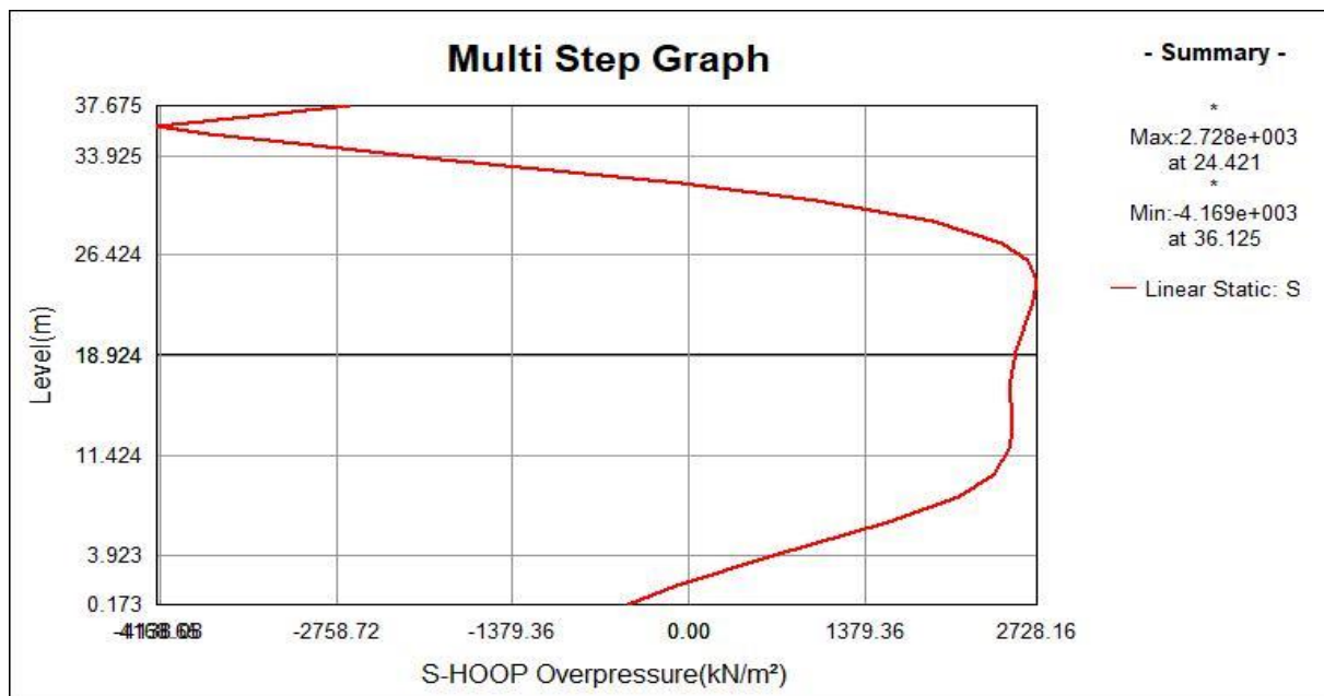
Figure 3.6 : Distribution verticale des contraintes circonférentielles sous effet de surpression de +387.5 mbarg.
