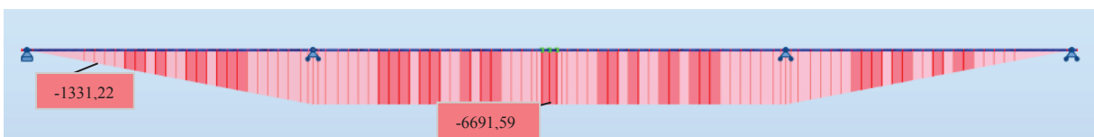
Figure. V. 13 : Moment fléchissant de gradient thermique.
