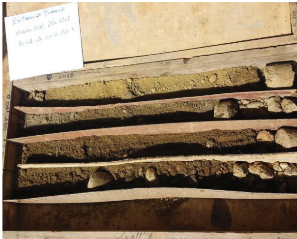
Figure A. 2 : SC2(Pile N°02) de 0.00 – 11.50m (Sable, gravier, cailloux à passer de galets.).
