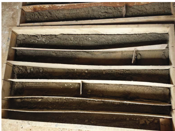
Figure A. 4 : Sondage SC 01 : de 0.00 à 25.0 m au droit de C1.
