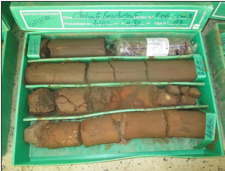
Sondage : F-06-CCM-B Caisse N° : F-06-CCM-B (2) Profondeur : 2,40m - 4,80m
