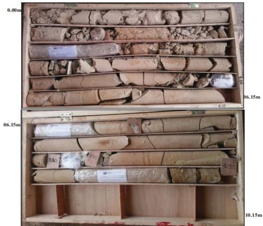
FigureV.3 : Photos des caisses à carotte du sondage S2-D-04 De (0.00 à 10.15m)
