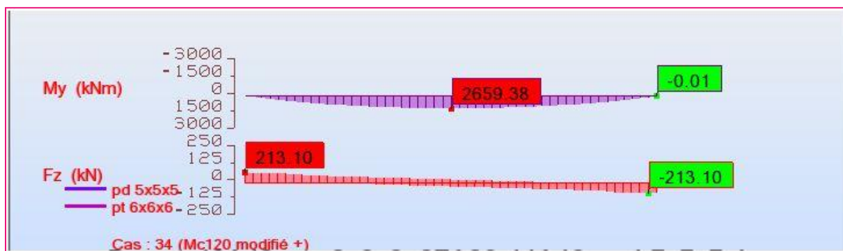
Fig : Réactions et diagramme de moment sous Mc 120.
